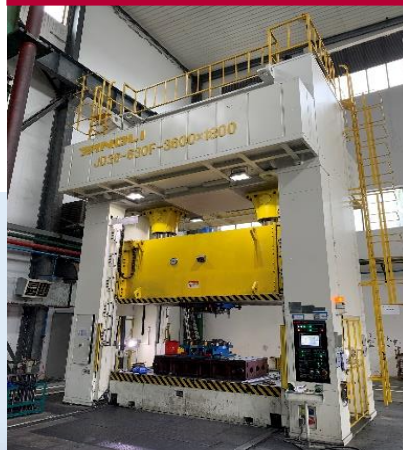
闭式四点单动机械 压力机630T
