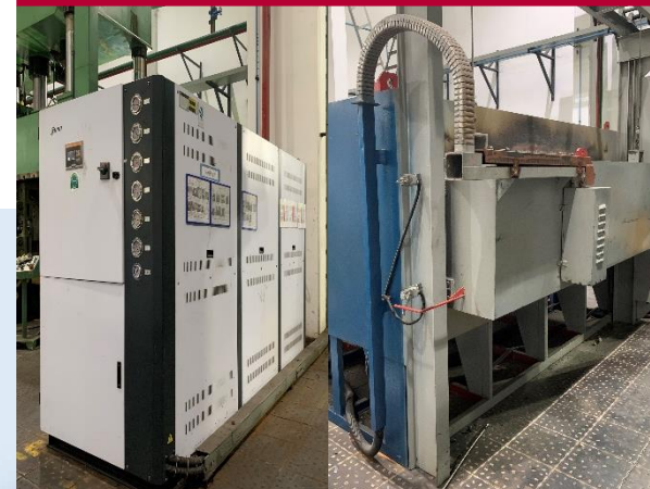
冷却系统、加热炉 热成型模具专用
