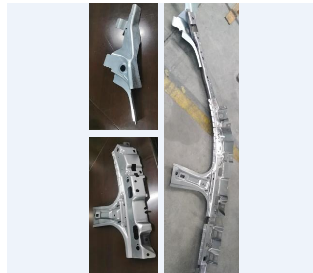
U540激光焊接件 液压管与冲压件激光焊接 极差0.3
