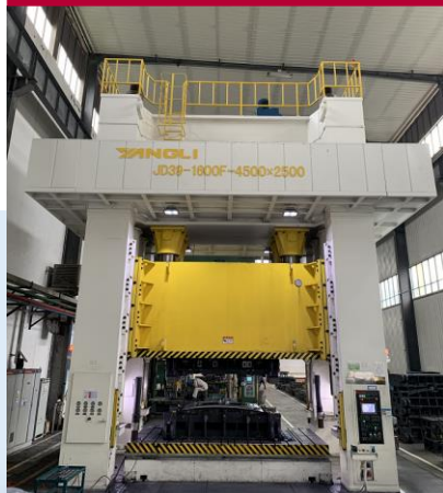
闭式四点单动机械 压力机1600T
